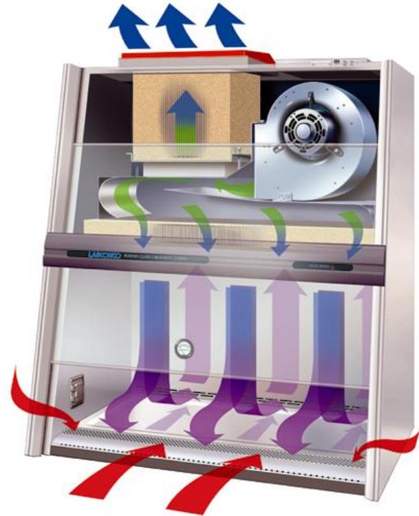
HEPA (High efficiency particulate air Filter), 高效空气过滤器, 达到HEPA标准的过滤网, 对于0.1um和0.3um的有效率达到99.998%, HEPA网的特点是空气可以通过, 但细小的微粒却无法通过。
